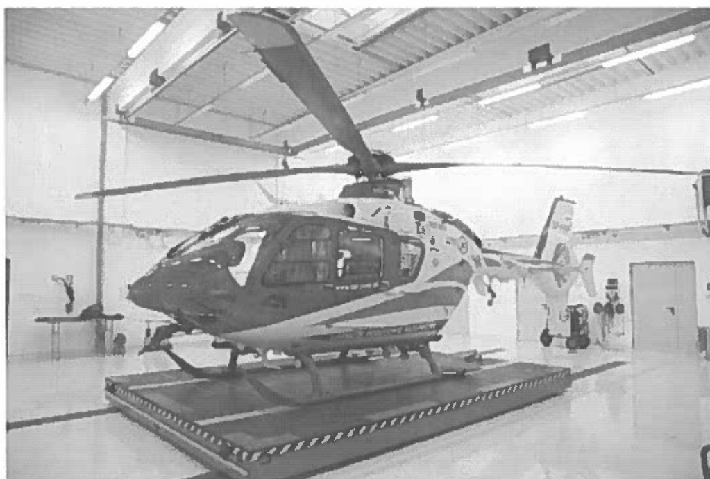
Śmigłowiec w bazie obsługi liniowej na przesuwnicy
