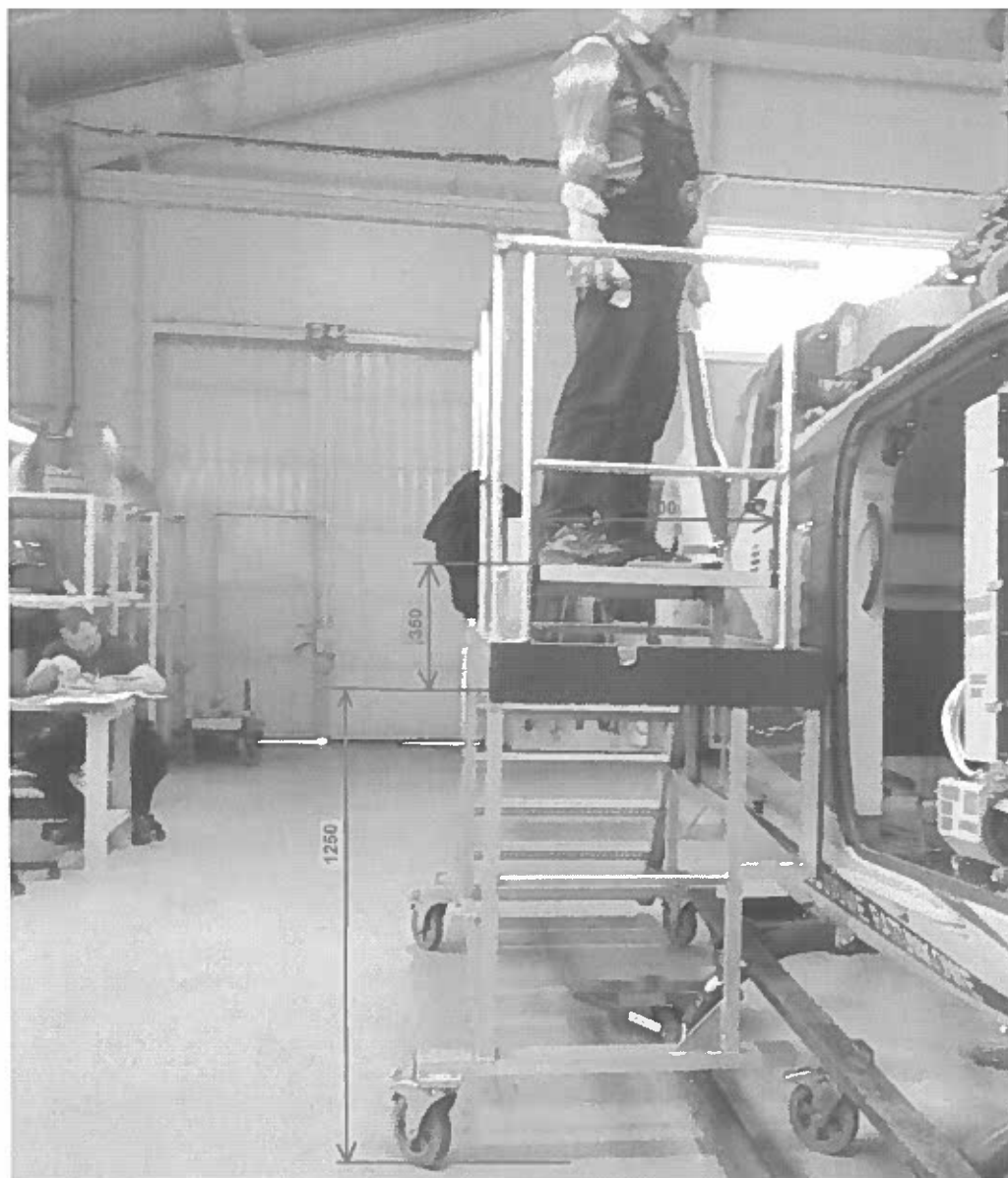
Podest do obsługi hangarowej w Stacjach Obsługi Technicznej w Warszawie i w Szczecinie
