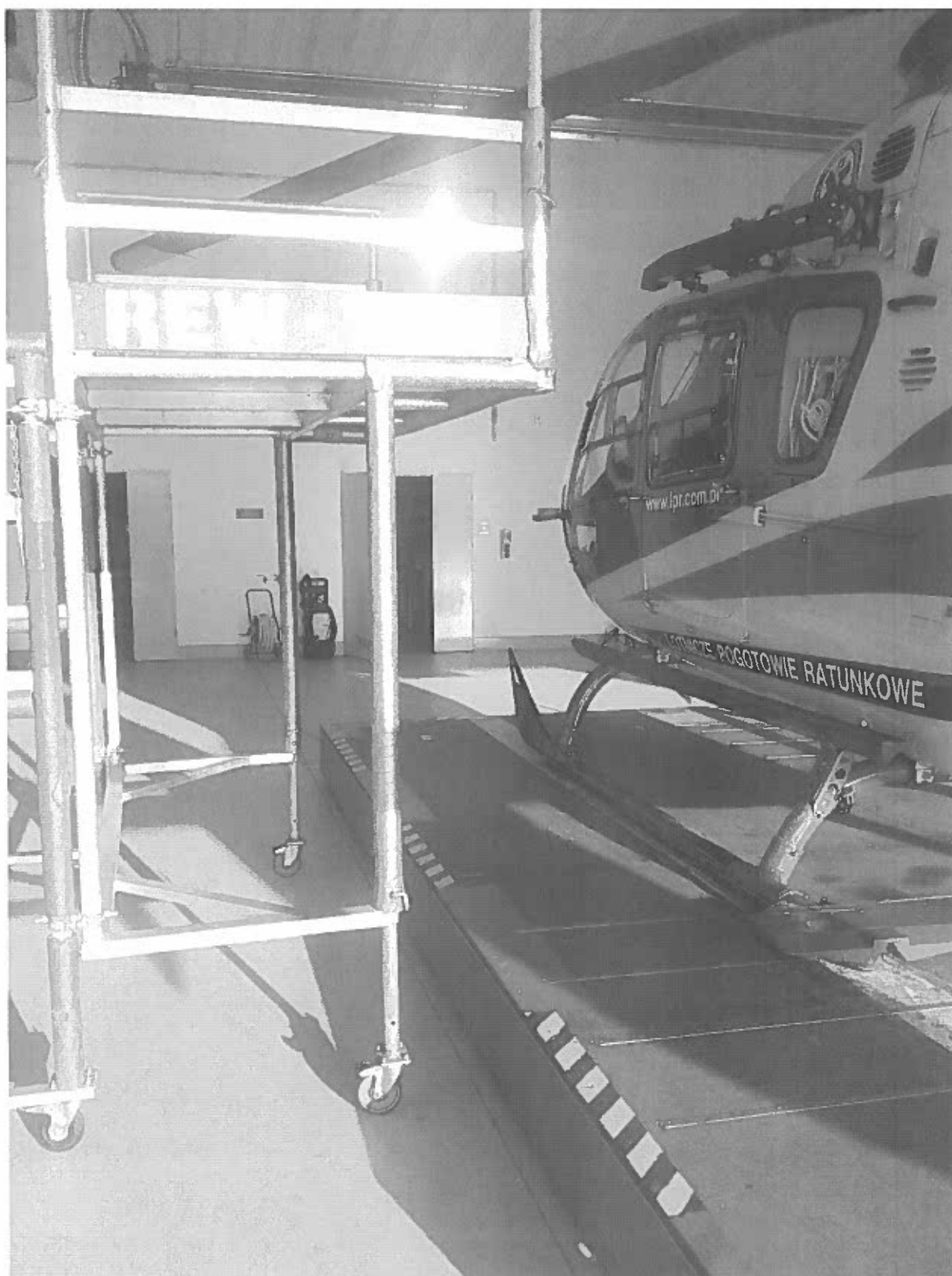
Dostawka z opuszczonymi kołami do pracy na płaskiej powierzchni
