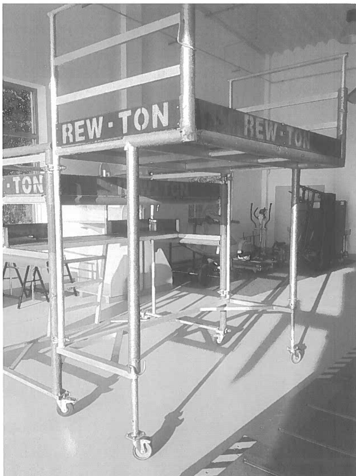
Podest obsługowy z dostawką do pracy na przesuwnicy
