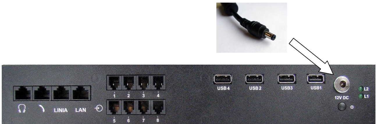
Rys. 8. Podłączenie zasilania do Konsoli
