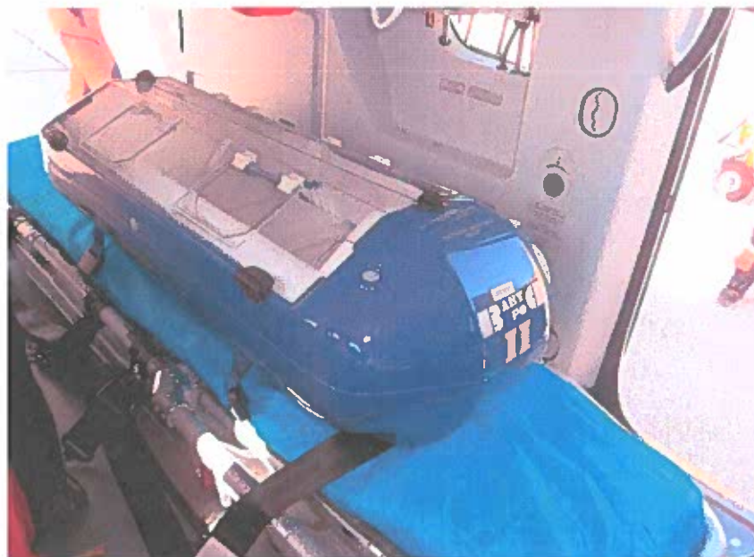
Zdjęcie pokazuje orientacyjne położenie inkubatora Baby Pod II na noszach w śmigłowcu EC135, na zdjęciu brak systemu mocowania.
