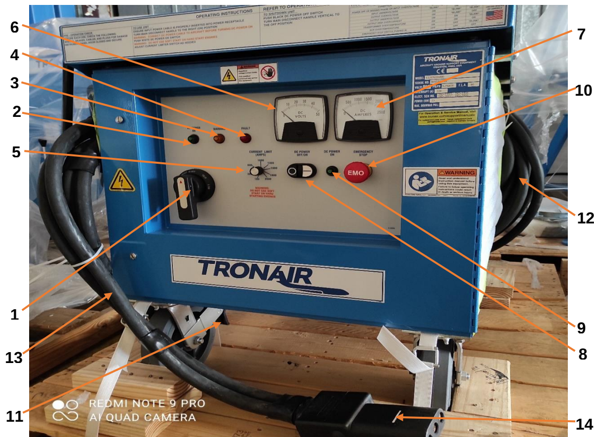
Rysunek 9 - Naziemne źródło zasilania TRONAIR
